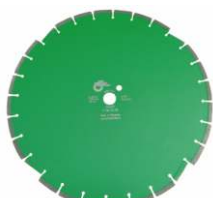
Tăiere umedă Prindere: Ø 25,4 mm Dinți de subțiere cu segmenti dubli. Aplicații: beton proaspăt turnat (de max. 36 h)
